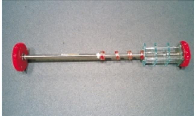
写真2 同じ極どうしの磁石を無理に近づける実験装置。
