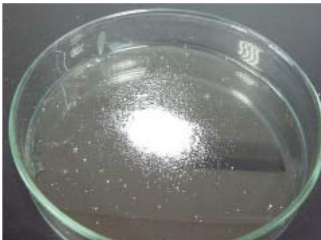
写真1 粉末の高吸水性ポリマー
