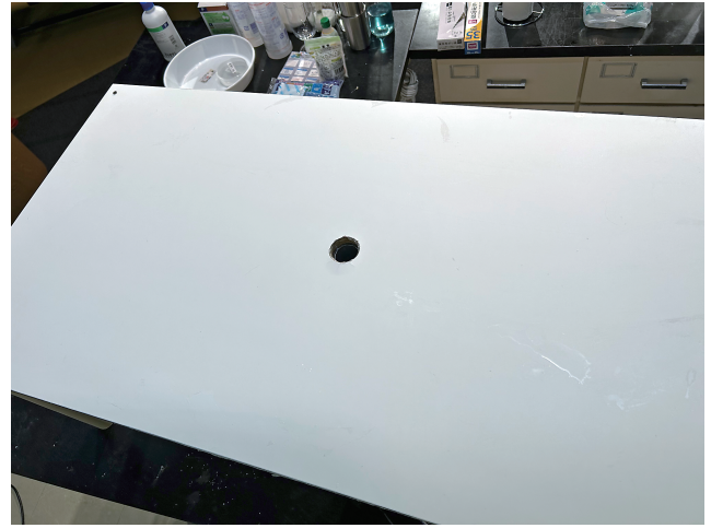
写真 11 中心に 30mm の穴を開けたテーブル
