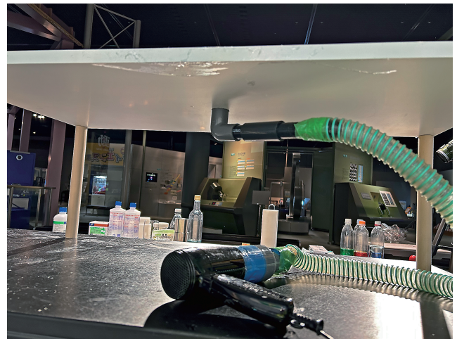
写真 12 テーブルの穴にドライヤーをつなげて下から空気を送り込む
