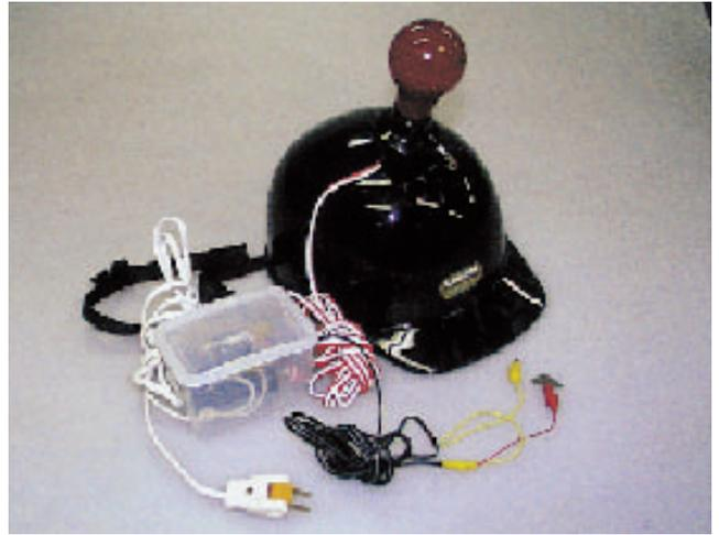
写真2 弦の導電性演示装置。みの虫クリップをギターブリッジにはさみ、金属ピックで演奏するとヘルメットの電球が点灯する。ショーの間は実験道具に注意が届かない場合もあって事故の危険性が大きいので、電球はコンセントから電源を取っている。弦の導電性はその際のスイッチに使っている。
