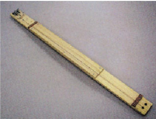
写真9 弦による音程実験器。1弦と6弦が張ってある。ピッキング部分とフレット部分は殺をつけている。ドリルであけた穴にワッシャーを貼りつけることで、弦の端の金具を詰まらせて固定している。他端はワイヤー固定具で環状にしたものをフックボルトに引っかけて固定している。
