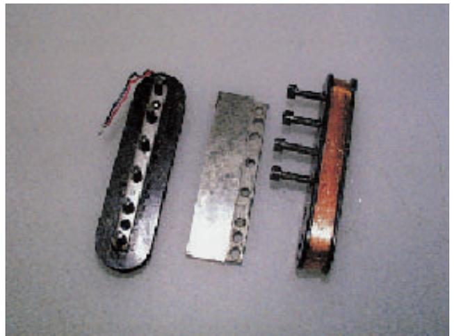
写真6 分解したマグネティックピックアップ。コイルから飛び出しているのはポールピースと呼ばれる金属芯、穴のあいた板はポールピースホルダー（金属板）、磁石（穴のあいていない板）、コイルでピックアップは構成されている。
