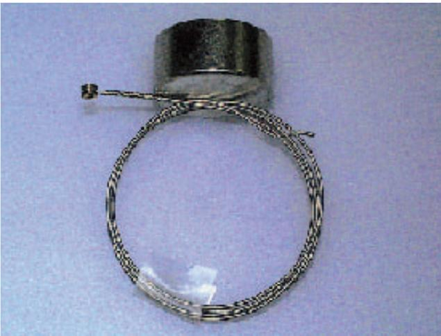
写真3 弦の磁化演示具、6弦を使用した。実験では1本の状態で紹介し、その場で巻いて磁石とともに手で持って磁化の実験をした。
