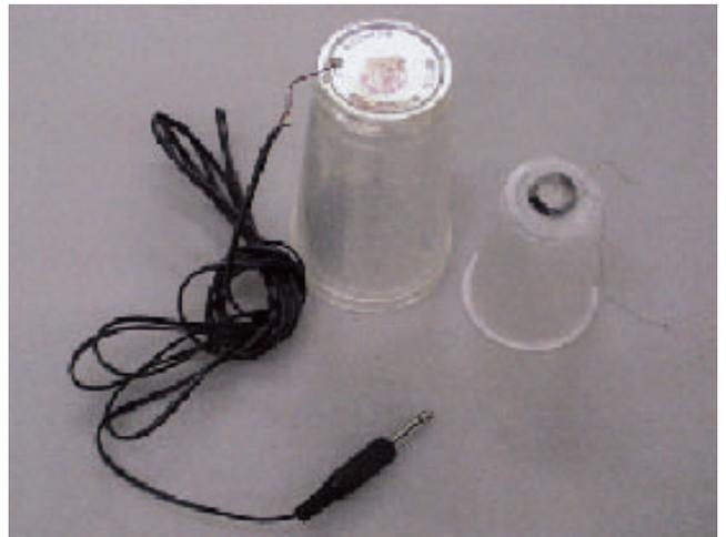
写真10 簡単スピーカー・マイク。サイエンスショーには大型のコップを2重にして使用した。実験教室には小型のものに直接貼りつけている。
