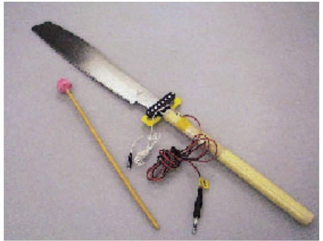
写真8 エレキノコギリ。鋸の根元にピックアップを設置した。演奏はマレットでたたいた。鋸部分を湾曲させると音階が刻める。
