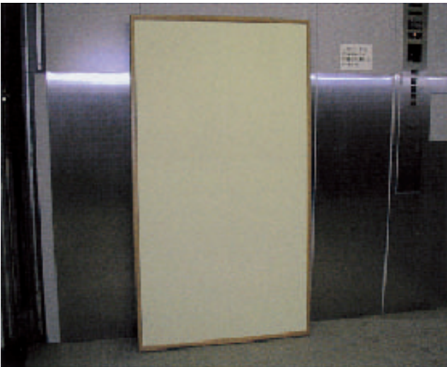
写真3 蓄光シート. 表面には全面にシートを貼りつけている. 台は木製.
