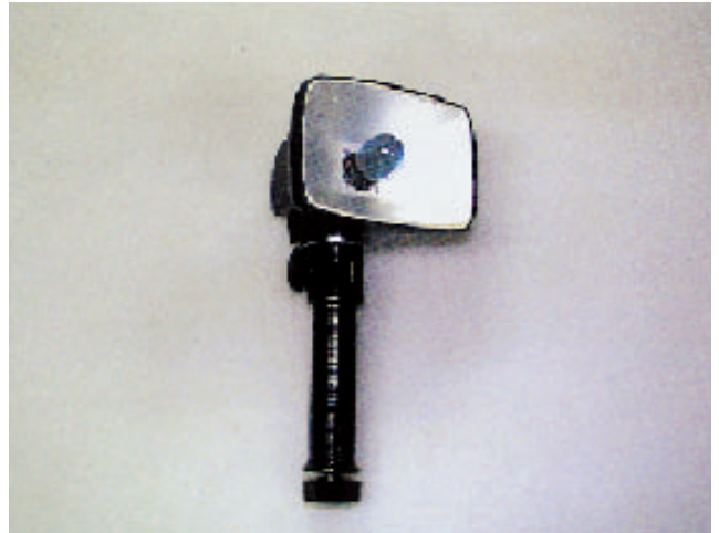
写真2 閃光電球用フラッシュガン. 傘の裏に点灯用のスイッチがあり、電球装着時に事故がよく起こった.
