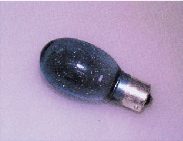
写真1 閃光電球. 内部に金属ワイヤー（アルミニウム、ジルコニウム）が封入されているのが見える. 発光時にこの金属ワイヤーが燃焼し、球にひびが入り、内表面には球形の酸化物が付着する.
