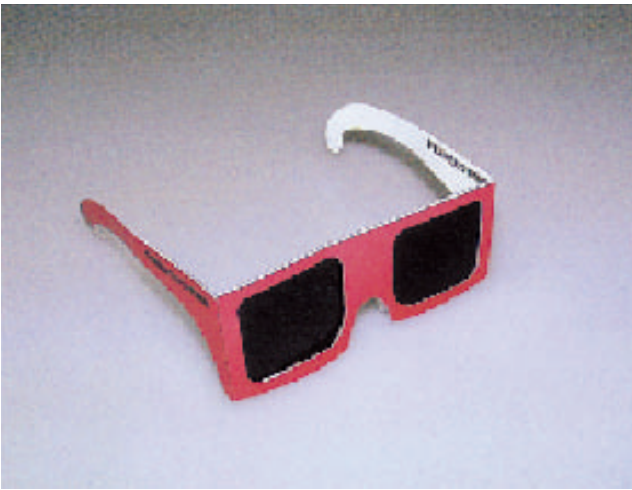
写真1 自作サングラス。フレームはケント紙。2重の型紙がレンズをはさむ仕組み。レンズはグレーの亚克力板に車のスモークシートを貼りつけたもの。回折格子レプリカは片目のみに貼っている。
