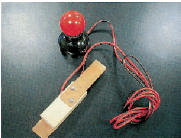
写真3 表皮電流確認装置、表皮電流を肌で感じるができないので、手に電極を持って電球を光らせることで確認する装置。絶縁させた2つの電極に電球を接続させて、一つはテスラコイルの電極に、他方は手で持って、もう片方の手でテスラコイルの電極に触れる。
