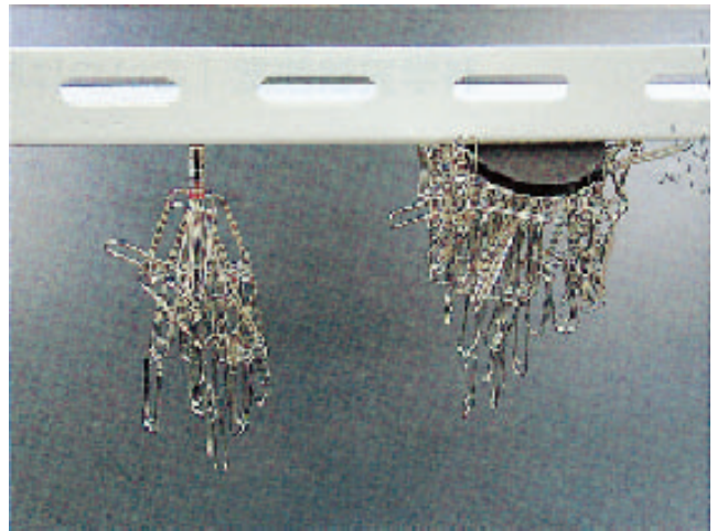
写真2 表面磁束密度の実験、右手のフェライト磁石の方が付いているクリップの量は多いが、手でクリップを離すと左のネオジム磁石の方が強いことが実感できる。
