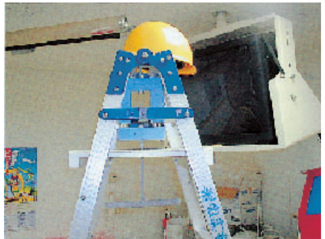
写真3 磁石の力で体を支える実験装置。もともと電磁石で体を支える実験のために製作した。鉄製、脚立に設置し、ボルトなどで5重の落下防止策をとっている。念のためヘルメットを着用する。
