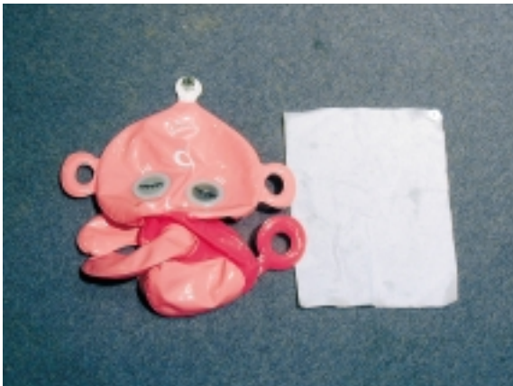
写真3 真空落下に使用した落下物．羽やティッシュペーパーなどのきわめて軽い素材に金属片を固定すると，金属片に落下が引きずられてきれいに舞い落ちないので，少し重めの紙を使用した．人形はデシケーターの真空度を観覧者にも確認できるように，ビニル人形を使用した．
