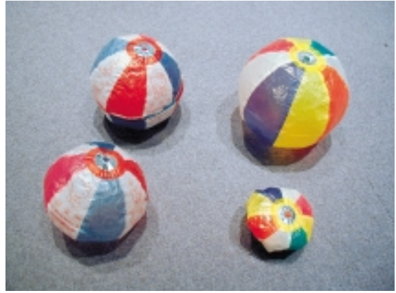
写真2 空気抵抗の大きさを評価するための紙風船．質量が小さいためほぼ終端速度に達する時間と落下距離が短く，その間の誤差が小さいので実験が容易である．
