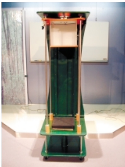
写真11 無重力観察装置正面。300ミリ立方の部屋を落下させる。部屋には CCD カメラを取り付けて、モニターで拡大した映像も映し出した。下の天板には衝撃吸収シートとゴムシート、わたのクッションを設置して落下衝撃を吸収した。実験は一瞬なので大半は見逃してしまう。実験後にあらかじめ撮影しておいた映像のスロー再生で検証した。
