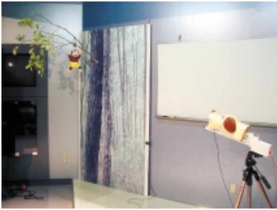
写真7 モンキーハンティング実験装置。ショーの演出上、標的と弾を大きく、射出距離を長くするために、大きな装置になった。ジオラマは天井吊り下げ、張り出した木の模型にコイルを設置して標的を吊り下げた。
