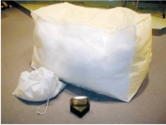
写真1 身体で支持する感覚と重さの違いを知るためのおもり．綿の入った布団袋，砂袋，鉄の塊を用意した．5 kgf 程度でも綿は抱えるほどの体積になるのだが，肩の強い負担などの方が印象的であるため，鉄の塊の方を重く感じてしまう．
