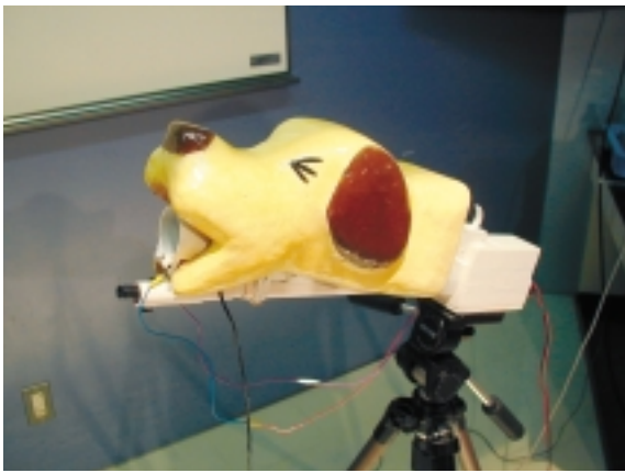
写真9 犬ランチャー。サルを撃つ装置。全体を犬の造形で覆い兵器らしく見えないようにした。
