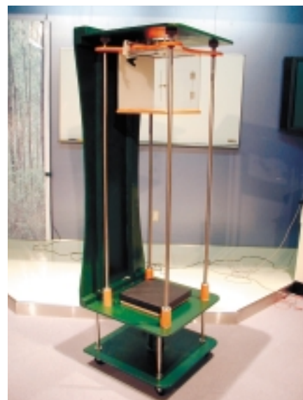
写真12 無重力観察装置側面。最上面の天板を固定するのは落下軌道を直線にする4本の柱と背板である。やはり来館者の視線をあげるために背板を底上げして、部屋が落下する範囲を高くしている。
