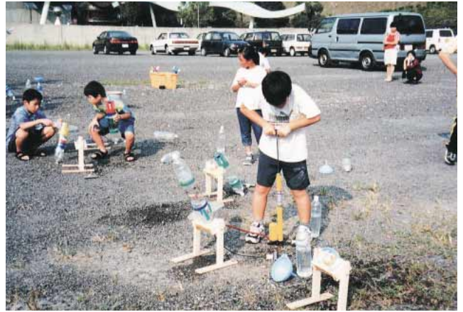
写真8 実験方法 水を3分の1から4分の1程度入れ、発射台に固定する。自転車の空気ポンプを接続し、40回程度ポンピングして加圧する。
