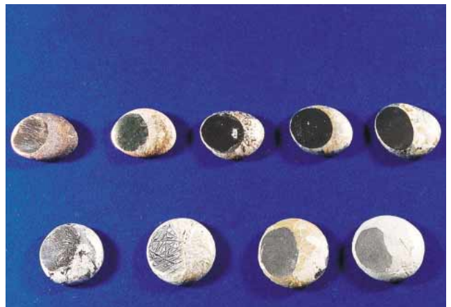
図3 得られた各組成のCu - Sn系合金 上段左から10, 20, 30, 40及び50wt%Sn, 下段左から60, 70, 80及び90wt%Snである。
