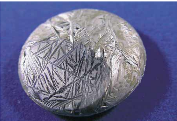
図5 70wt%Sn合金の研磨面に見られる鑄造組織
