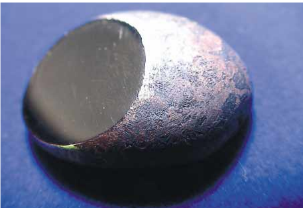
図4 10wt%Sn組成の合金（青銅）の研磨面鏡面に仕上げてある。
