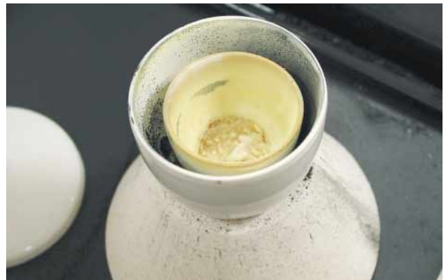
図7 昇華してつぼの回りに付着した亜鉛
