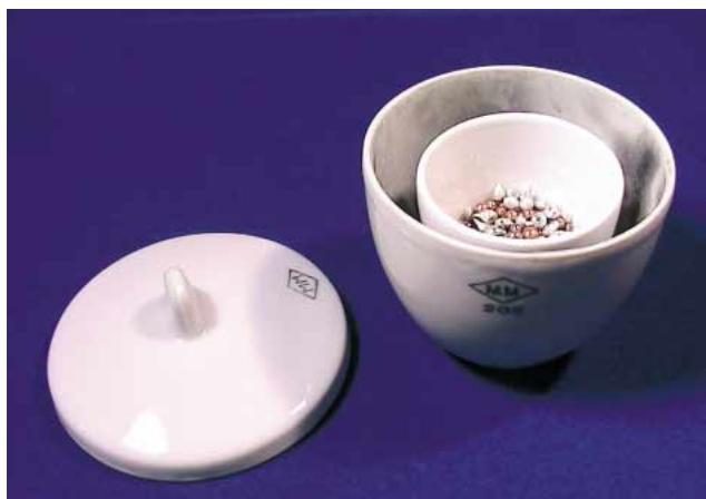
図1 加熱におけるるつぼの組み合わせ 大型るつぼの底に炭、小型るつぼには融解する粒状金属が入れている。
