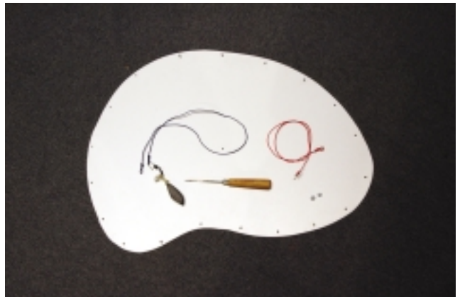
写真4 平面の重心を探す方法。 発泡塩化ビニル板の周囲内側に穴を空けて、おもりと一緒に吊るす。
