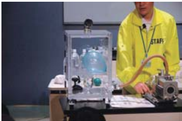
図13 真空ポンプと真空デシケーターと膨らむ風船。演示者は指定管理者職員
